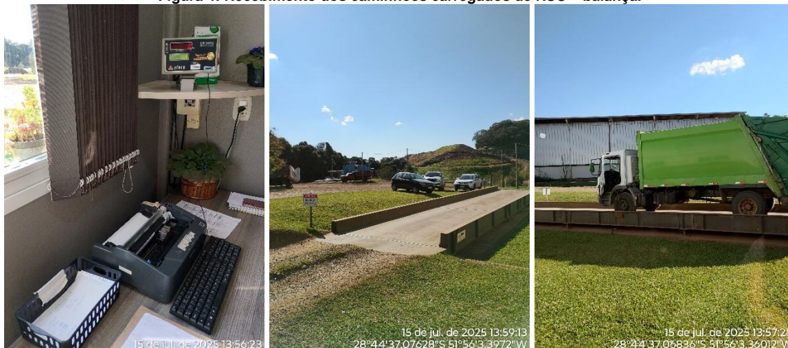
Figura 4: Recebimento dos caminhões carregados de RSU – balança.
