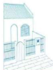
INSTALAÇÃO DA CAIXA DE PROTEÇÃO DE HIDRÔMETRO EM MURTA FRONTAL COM GRADE
