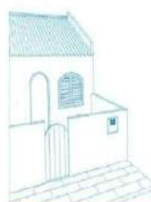
INSTALAÇÃO DA CAIXA DE PROTEÇÃO DE HIDRÔMETRO NO MURO FRONTAL
