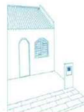
INSTALAÇÃO DA CAIXA DE PROTEÇÃO EM RESIDÊNCIA SEM MURO
