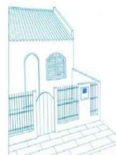
INSTALAÇÃO DA CAIXA DE PROTEÇÃO DE HIDRÔMETRO EM MURETA FRONTAL COM GRADE
