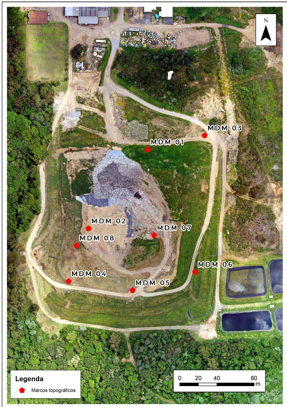
Figura 24: Localização dos marcos topográficos do aterro sanitário.
