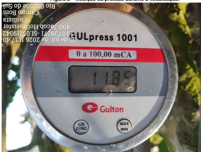
Figura 2 – Medição da pressão durante a fiscalização.
