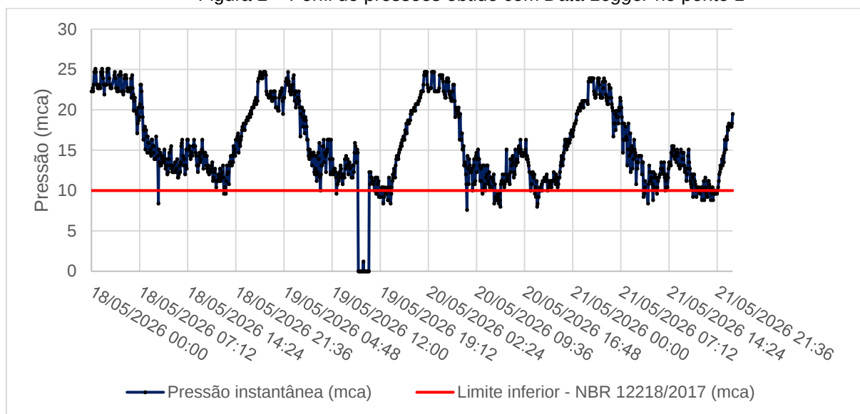
Figura 2 – Perfil de pressões obtido com Data Logger no ponto 1
