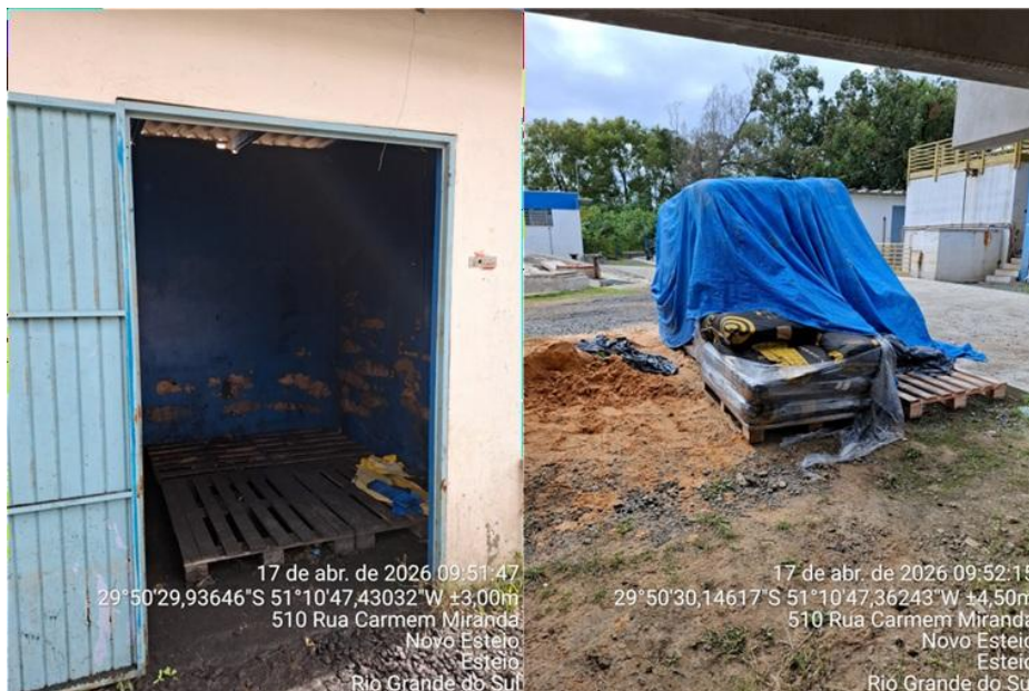
Figura 03: Recebimento de produtos químicos na ETA de Esteio. a) Recebimento de carvão ativado e b) Recebimento de ortopolisfosfato.
