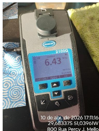
Figura 06. Identificação de análise com parâmetro de rede alterado em Sapiranga.
