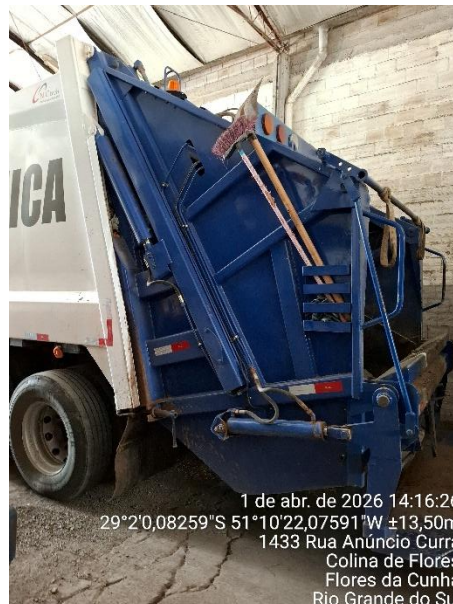
Figura 3 –Vista do compartimento de chorume de um dos caminhões
