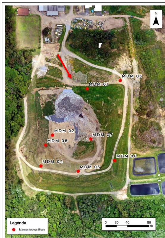
Figura 12: Imagem aérea onde verificou-se a movimentação de massa visível e lixiviado percolando
