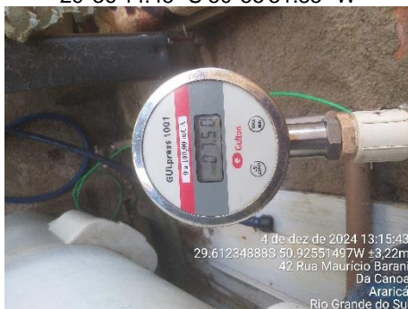
Figura 1 - Pressão medida 7,5 mca Coordenadas Geográficas: 29°36'44.45" S 50°55'31.85" W
