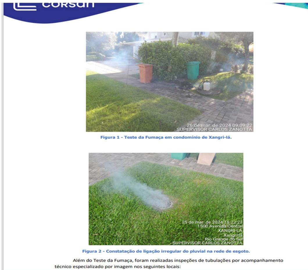
**Figura 4A- Ações de inspeção (c/teste da fumaça)**
