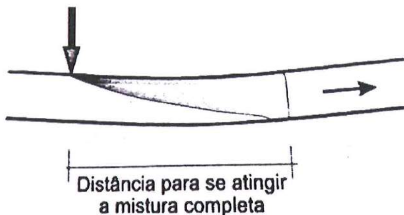
Figura 3.4 – Ilustração de processo que ocorre em uma zona de mistura de curso d'água (Fonte: VON SPERLING, 2007).
