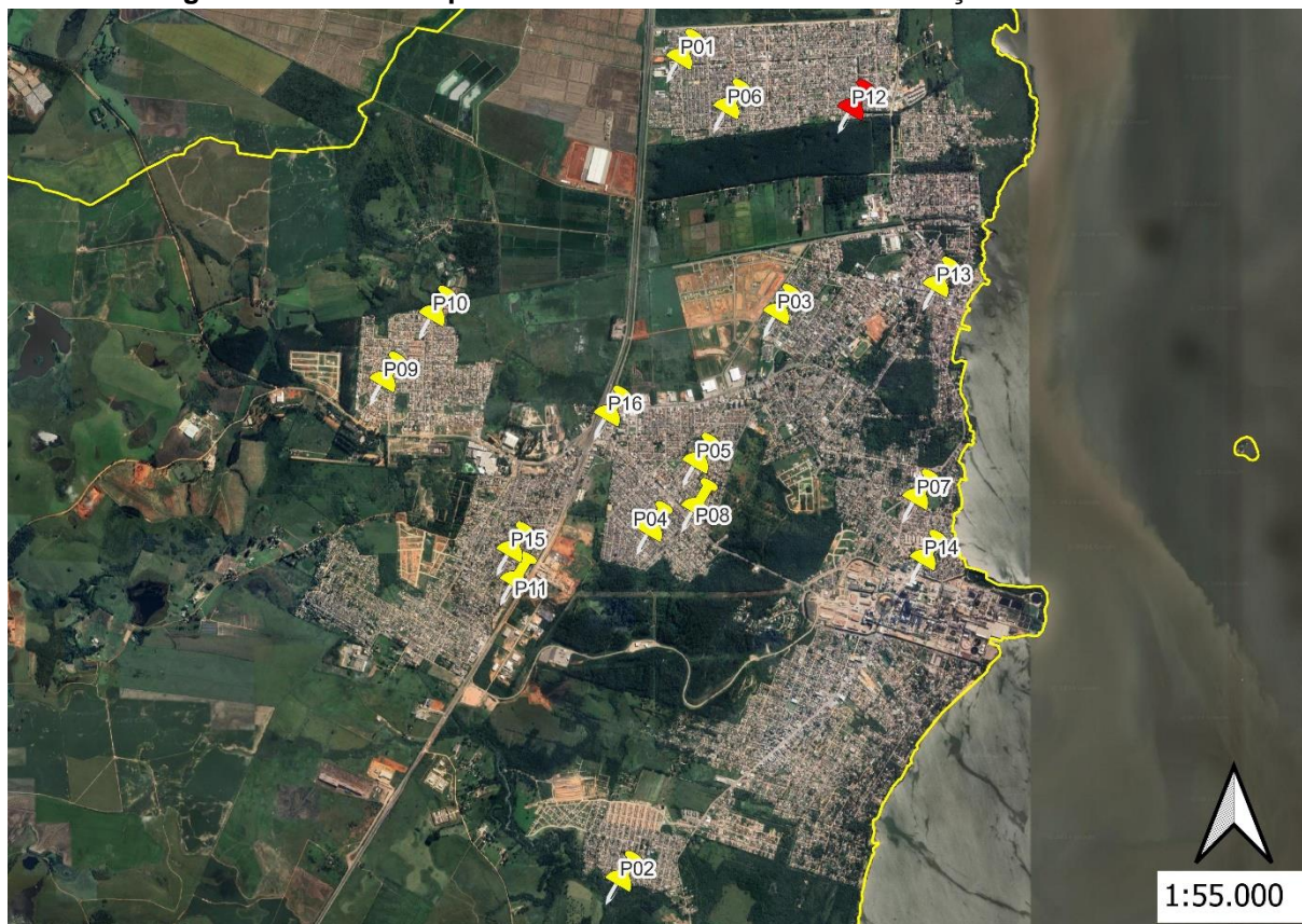
Figura 1 – Pontos de pressão aferidos na rede de distribuição em Guaíba.
