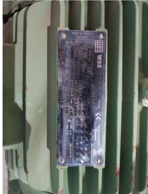
Figura 2p – Plaqueta de característica do motor 2.
