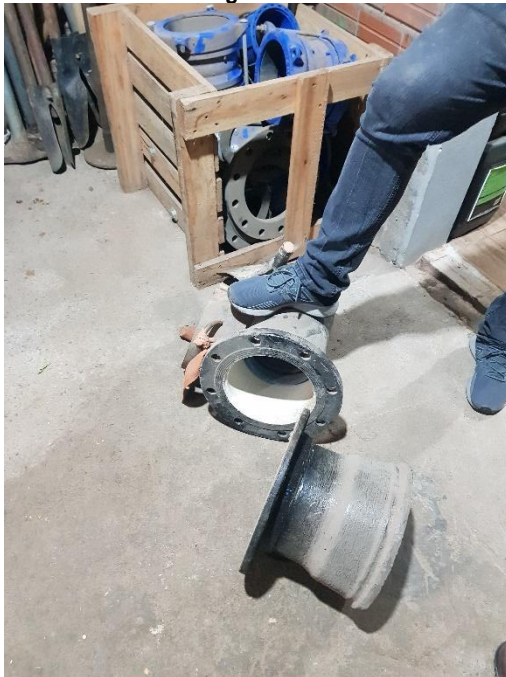
Figura 20c – VRP DN200 BERMAD (Caixa), Junções Axiais e Conexão com Bolsa e Flange
