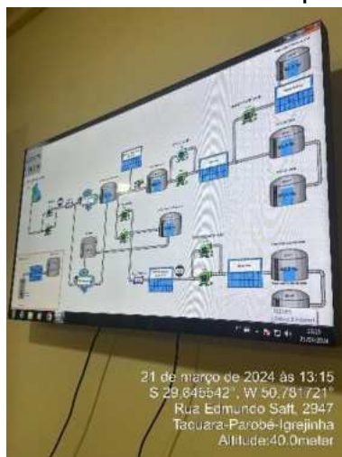
Figura 18: Sistema de telemetria do município de Taquara.
