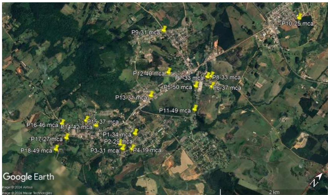
Figura 1 – Pontos de pressões aferidas na rede de distribuição em Capela de Santana.
