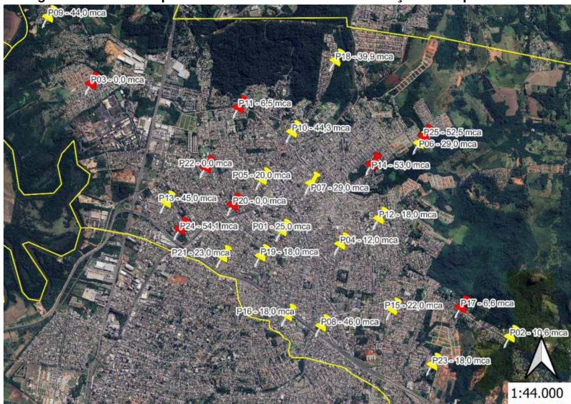
Figura 1 – Pontos de pressão aferidos na rede de distribuição em Sapucaia do Sul.
