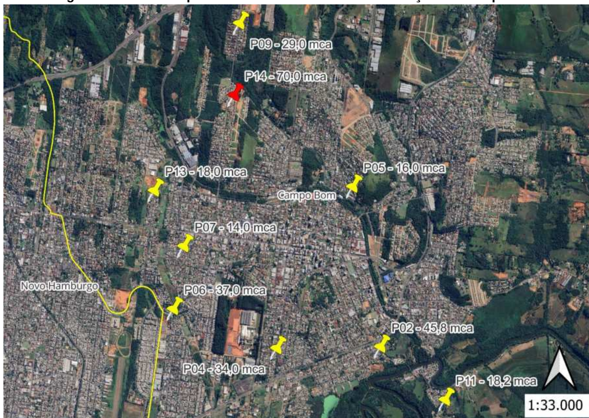
Figura 1 – Pontos de pressão aferidos na rede de distribuição em Campo Bom.
