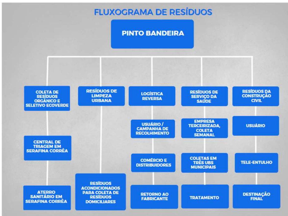
Figura 01: Esquemática do sistema de manejo de resíduos sólidos.
