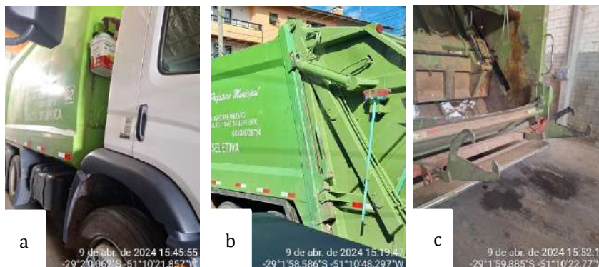
Figura 04: Veículos coletores de resíduos sólidos urbanos de Flores da Cunha. a) Vista lateral dos caminhões compactadores; b) Identificação específica dos veículos; c) Sistema de acoplamento para coleta mecanizada.
