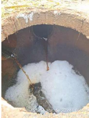
**Figura 17: Medição de vazão de chorume que escoo para lagoas de armazenamento.**
