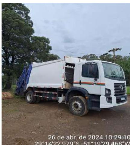
A ECOFAR possui a sua disposição sete (7) veículos compactadores coletores, como o da figura 01, para realizar as atividades de coleta de resíduos nas rotas estabelecidas. Estes caminhões possuem a capacidade de carga de sete (7) m<sup>3</sup>.
