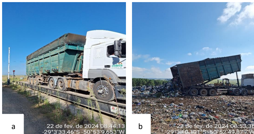
Figura 15: Destinação final de rejeitos de Caxias do Sul. a) Pesagem do caminhão na entrada da unidade; b) descarga de rejeitos no aterro.
