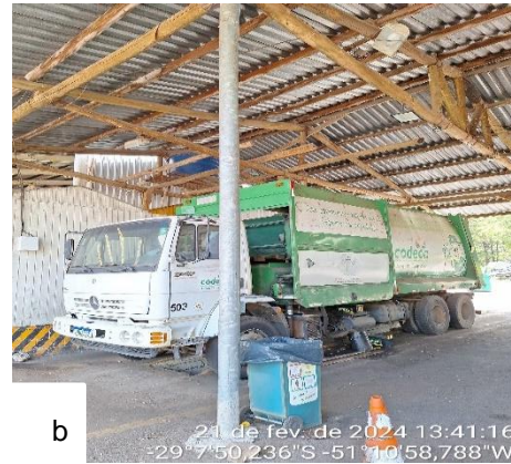
Figura 6: Caminhões para as coletas manual e mecanizada. a) Caminhão coleta manual, sem sistema Lifter ; b) caminhão coleta mecanizada, com sistema Lifter .
