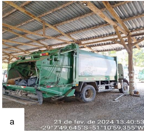
Figura 6: Caminhões para as coletas manual e mecanizada. a) Caminhão coleta manual, sem sistema Lifter ; b) caminhão coleta mecanizada, com sistema Lifter .
