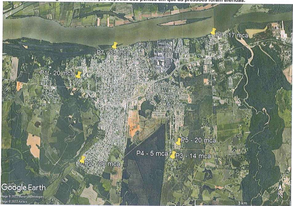
Figura 17: Distribuição especial dos pontos em que as pressões foram aferidas.
