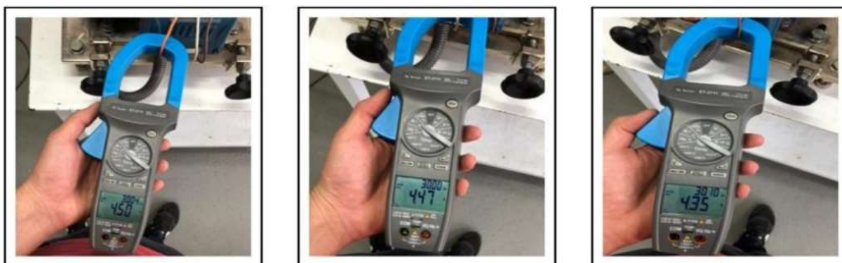
Figura 14 – Medição das correntes do motor
