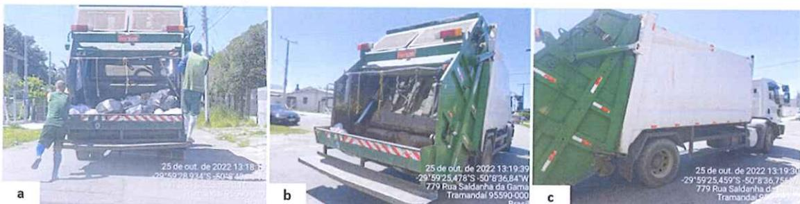
A dos Resíduos Sólidos Domésticos (seletivos) é realizada por meio de caminhões equipados com baú não compactador de no mínimo 15 m<sup>3</sup> de capacidade de carga, ou baú compactador de no mínimo 12 m<sup>3</sup> de capacidade de carga, de ano não inferior à 2007, sendo utilizado um único caminhão independentemente da temporada.
