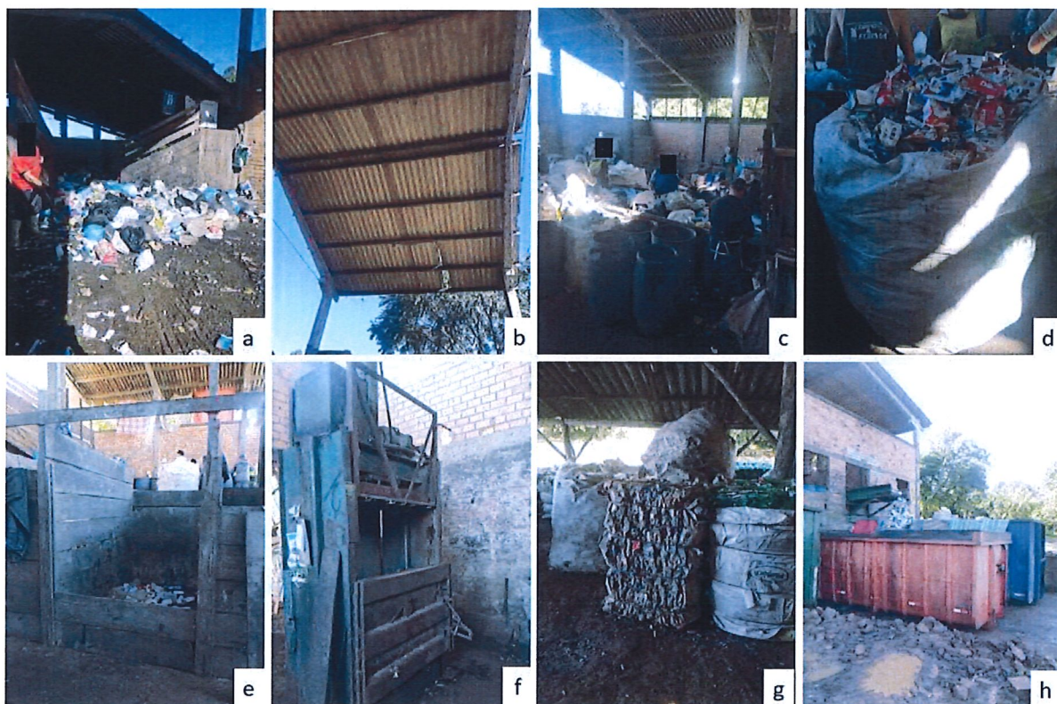
Figura 2 – Registros fotográficos da central de triagem. a) Vista do local de chegada dos resíduos; b) Vista da cobertura do local de chegada, com avarias; c) Vista da esteira de triagem; d) Vista de material classificado em saco de estopa; e) Vista das baias de acondicionamento; f) Vista da prensa compactadora; g) Vista dos fardos de material segregado; h) Vista dos containers para destinação final.
