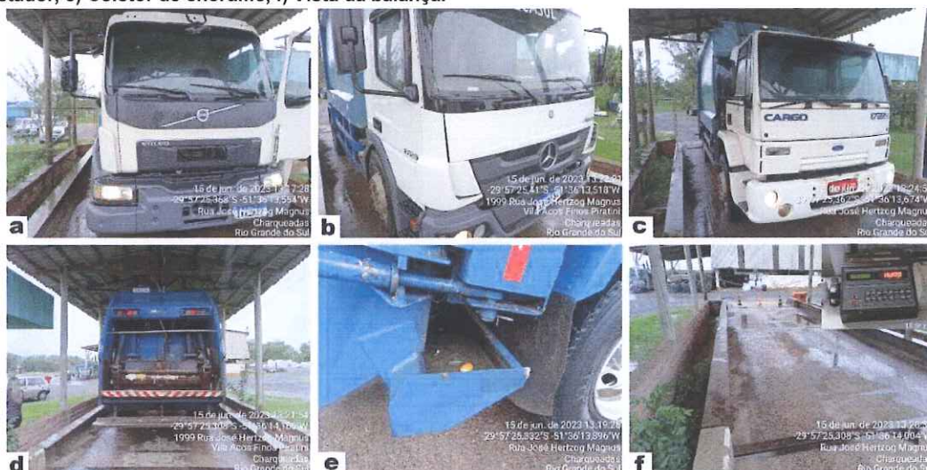
Figura 3: Caminhões disponibilizados: a) Veículo ano 2015, b) Veículo ano 2015, c) Veículo ano 2011, d) Vista do compactador, e) Coletor de chorume, f) Vista da balança.
