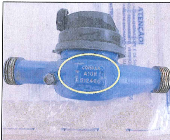
Figura 3 - Registro fotográfico do hidrômetro substituído, vista lateral com código aparente.
