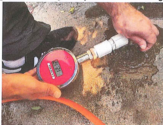
Figura 4: Registro fotográfico da medição de pressão na Rua da Igreja (antiga Rua E), n. 81
