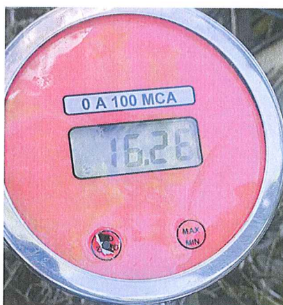
Figura 4: Registro fotográfico da medição de pressão na Travessa dos Canudos Esquerda, n. 4.570
