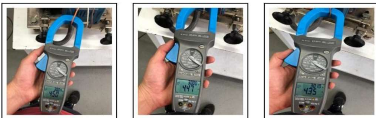
Figura 14 – Medição das correntes do motor
