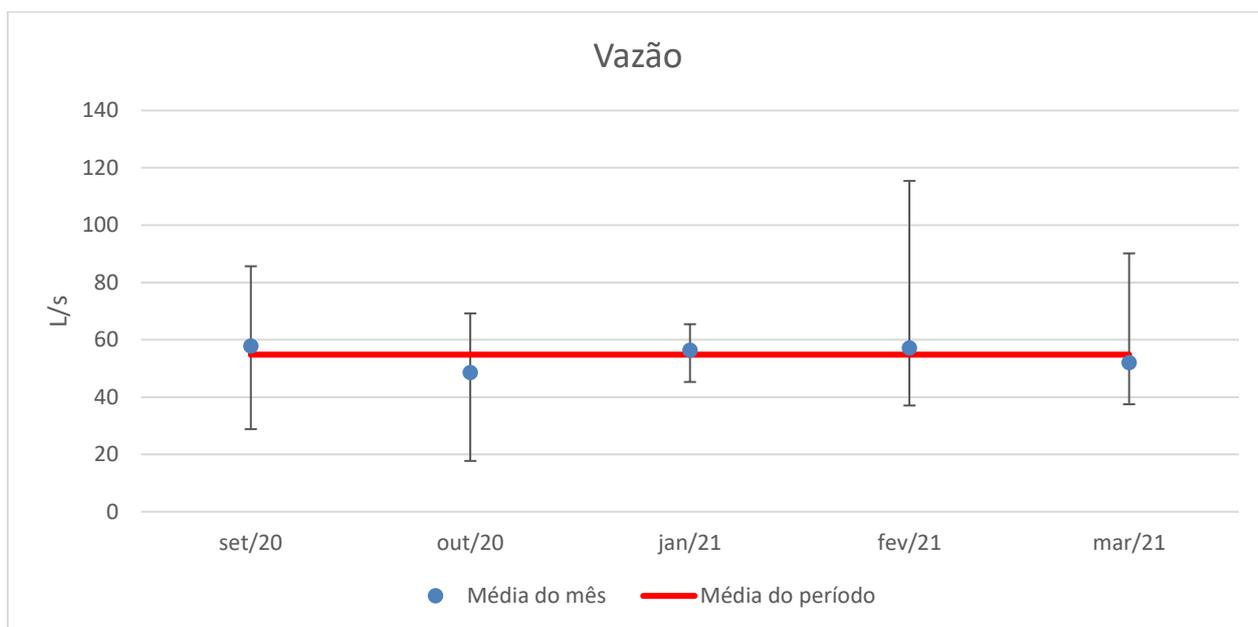
Figura 14. Monitoramento da vazão do afluente na ETE no período.
