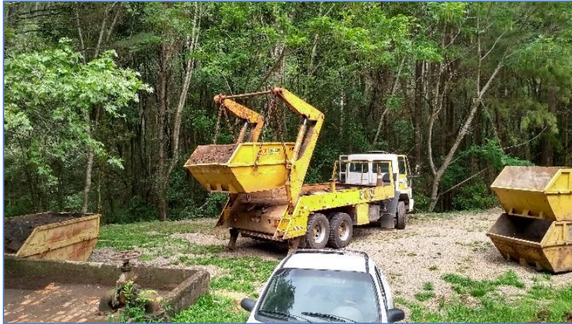
Foto 9. Remoção de lodo desidratado.
