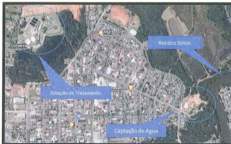
De acordo com informações fornecidas pela CORSAN através do Anexo II, Campo Bom dispõe uma ETE, vinte reservatórios, do tipo semienterrado, apoiado ou elevado, com capacidade total de 6.050 m<sup>3</sup> de água, de catorze Estações de Bombeamento, 64,5 km de adutoras e 279,9 km de rede de distribuição. Apresenta uma central Comercial e Operacional, na qual possuem 16.726 ligações, num total de 24.890 economias, representando 99,76% do percentual de hidrometração.
