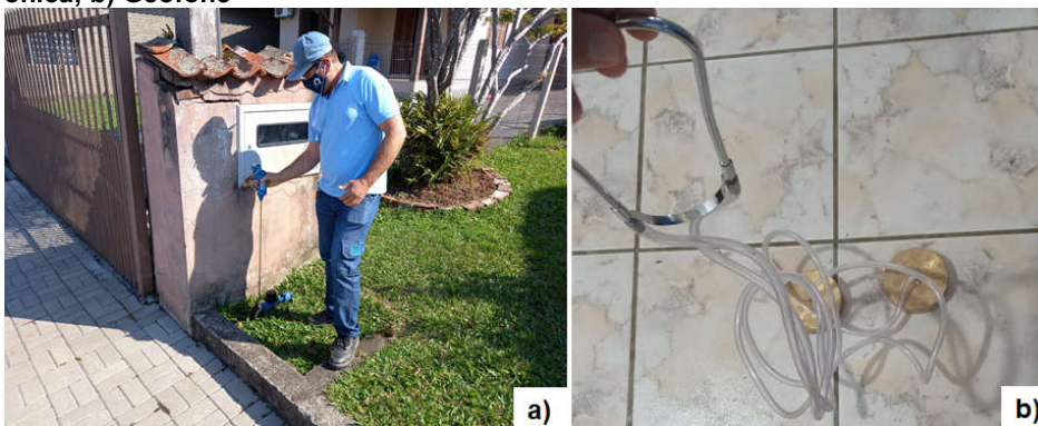
Figura 33 – Registros fotográficos dos equipamentos utilizados pela CORSAN em Rolante. a) Haste de escuta eletrônica; b) Geofone
