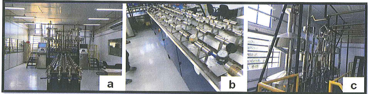
Figura 2: Bancada para teste de aferição. a) Vista da bancada de aferição; b) Local de posicionamento dos hidrômetros testados; c) Equipamentos para medição de massa.
